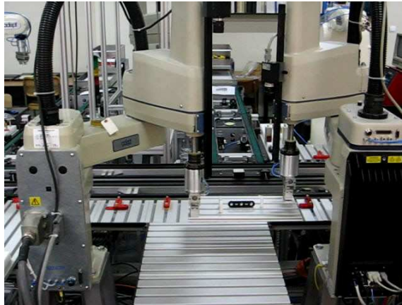
Figura 6. Aplicație de manipulare folosind mișcări robot sincronizate.
